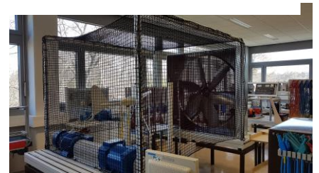
Abb.4.: Konstruktion mit Sicherheitsnetz
