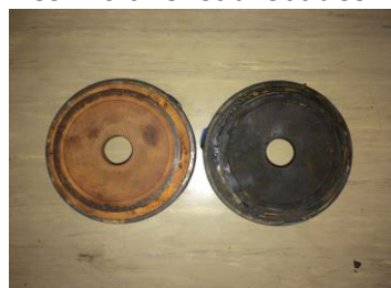
Abb.2: Die Reinigung mittels eines Zitronensäurebades
