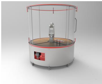
Abbildung 1: Modulare Sicherheitszelle ABB IRB 120
