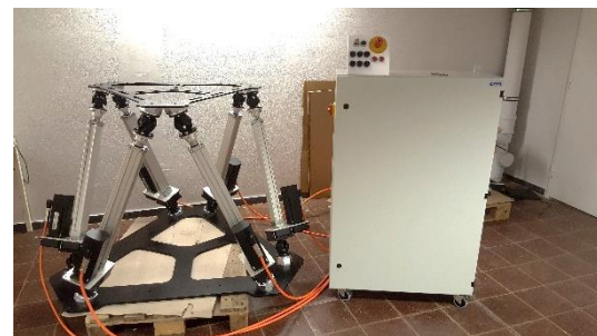
Abbildung 2: Stewart-Plattform mit Schaltschrank
