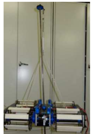
Abb.: 2 Messen der Auftriebswerde an der Führungstange
