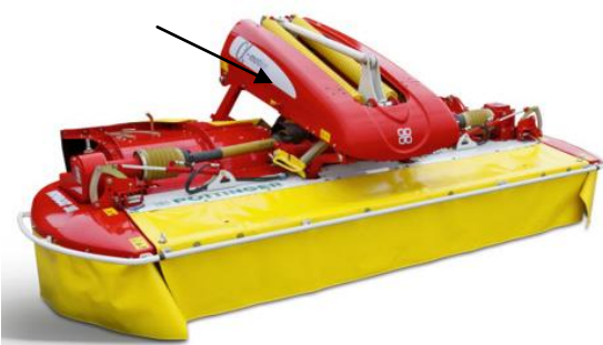
Abb1: Frontmähwerk mit Alpha Motion-Anbau (Pfeil)
