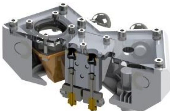
Abb.1 - Der neu entwickelte Druckkopf in der Schnittansicht
